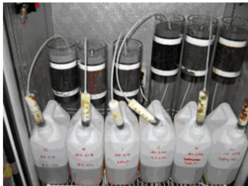
Kolonnförsök från rapporten Utvärdering av analysmetod för fritt lösta organiska ämnen.
