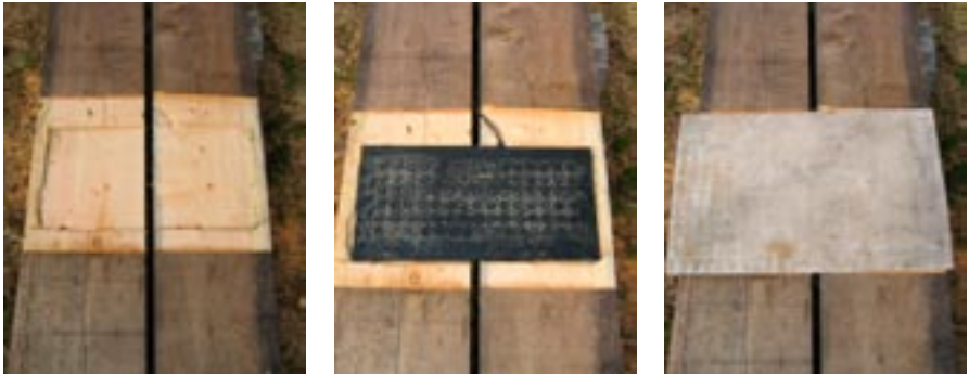
Tryckplattor fungerar bra sommartid och särskilt bra på fasta ytor som gångbroar. Enare strövområde, Finland. (FOTO: JOEL ERKKONEN)
