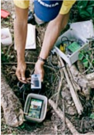
Överföring av data från datasamlaren till en handdator.
