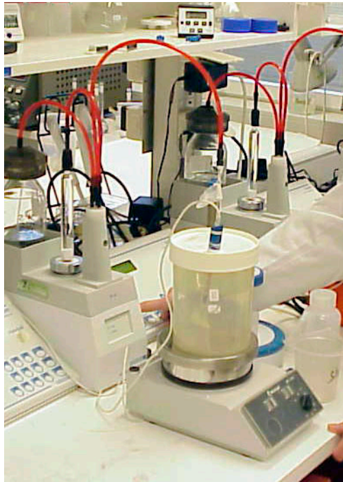
Figur 5 pH-statisk lakning där pH mäts kontinuerligt i provet. Syra/bastillsatsen sker automatisk så att ett konstant pH erhålls.
