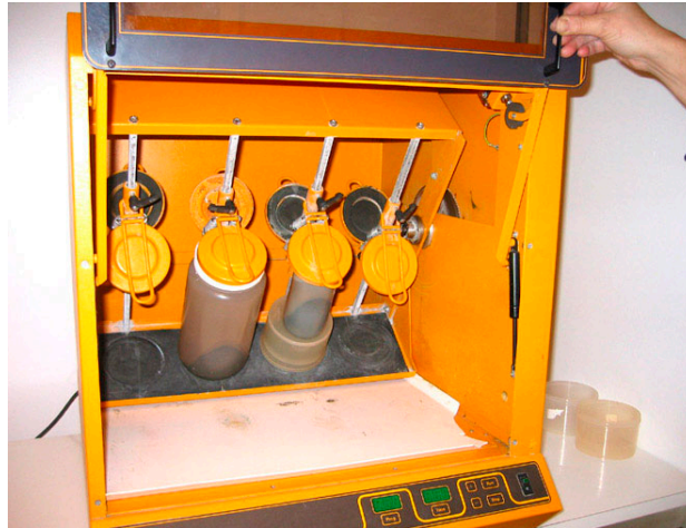
Figur 1 Skaktest med tvåstegslakning där provet skakas med avjoniserat vatten i två steg.
