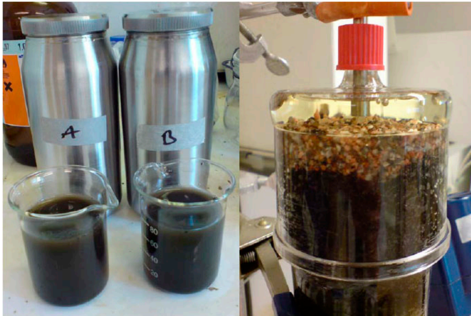
Figur 13. I bägarna (bilden till vänster) syns lakvatten från skakförsök med Gr 2:0-15 efter centrifugering. Trots centrifugering i 5 h var supernatanten som en svart grumlig lösning. Till höger syns klart lakvatten i toppen av en ER-H-kolonn som återcirkulerats i 7 dygn genom samma provmaterial.
