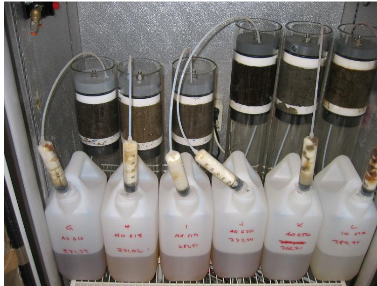
Figur 3. Kolontest för uppskattning av potentiellt läckage till grundvattnet. PUF används för att binda det dioxin som utlakats från jorden och passerat genom ett 1- \mu m glasfiberfilter
