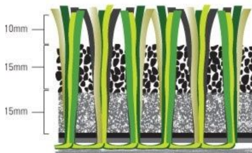
Figur 1: Ett konstgrässystem består av fibrer (grässtrå), backing (underlag där fibrerna fästs), ibland wrappingtrådar (trådar som fäster fibrerna i underlaget), ofta en sviktpad och granulat. Bild från Alphaturf
