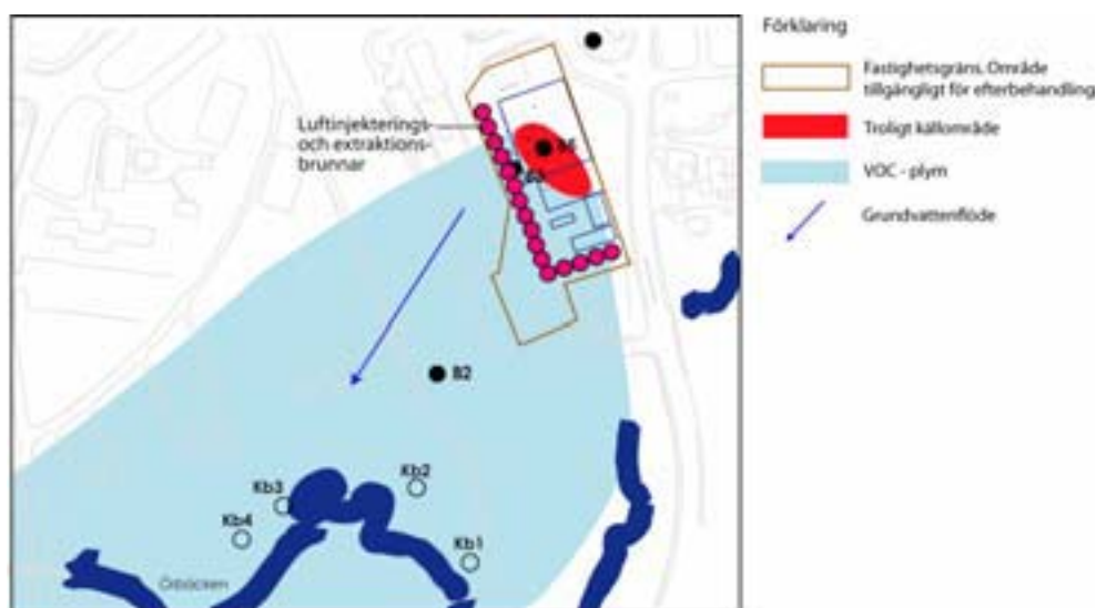
Figur B3.3. Alternativ 4. Luftinjektering och porgasextraktion.
