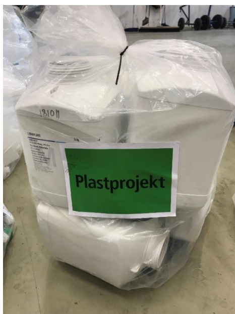
Figur 8: Burkar som innehållit salt. Plasten HDPE innehåller troligen pigment/fyllmedel och är därför inte transparent som övriga flaskor.
