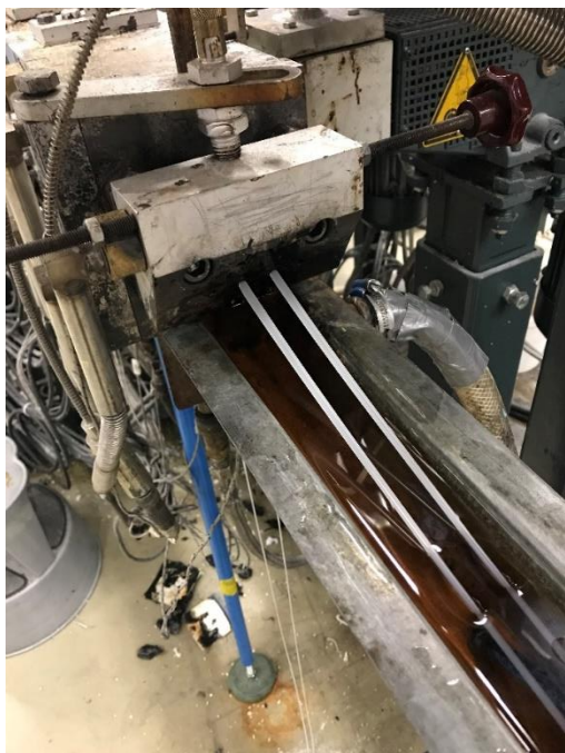
Figur 11: Två plaststrängar när de kommer ut ur compoundern och kyla i ett vattenbad.
