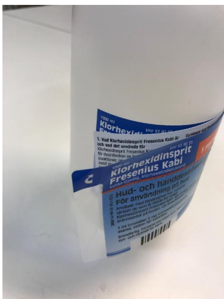
Figur 6: Klorhexidin-etiketten visade sig bestå av en liten pappersfolder med information om produkten och denna smälter inte tillsammans med plasten.
