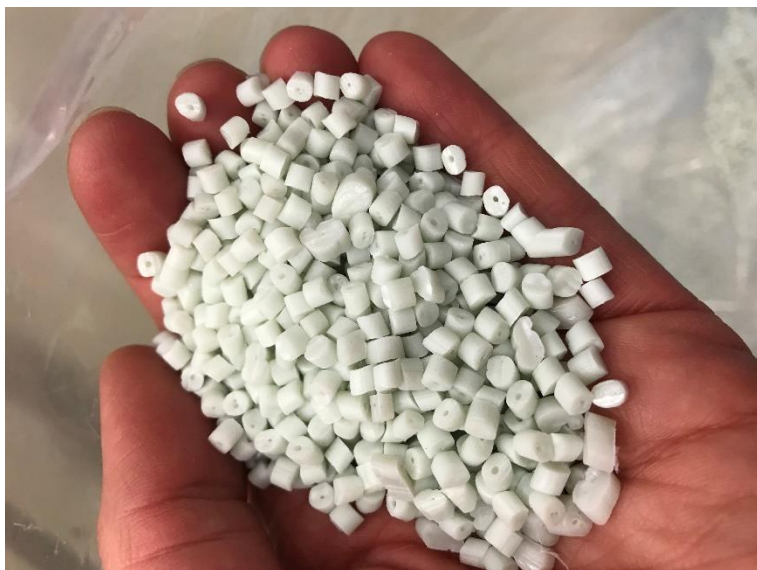
Figur 13_ Pellets från HDPE flaskor där färg från etiketterna gör materialet ljusblått.
