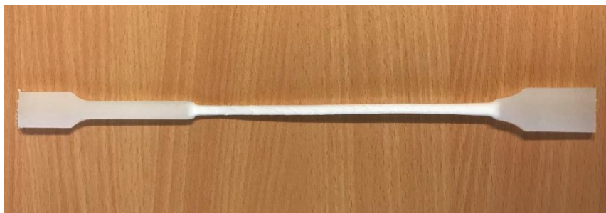
Figur 14: Bilden visar en dragprovkropp i PP som inte gick av. Den tunnare delen visar var materialet har flutit och töjt sig.
