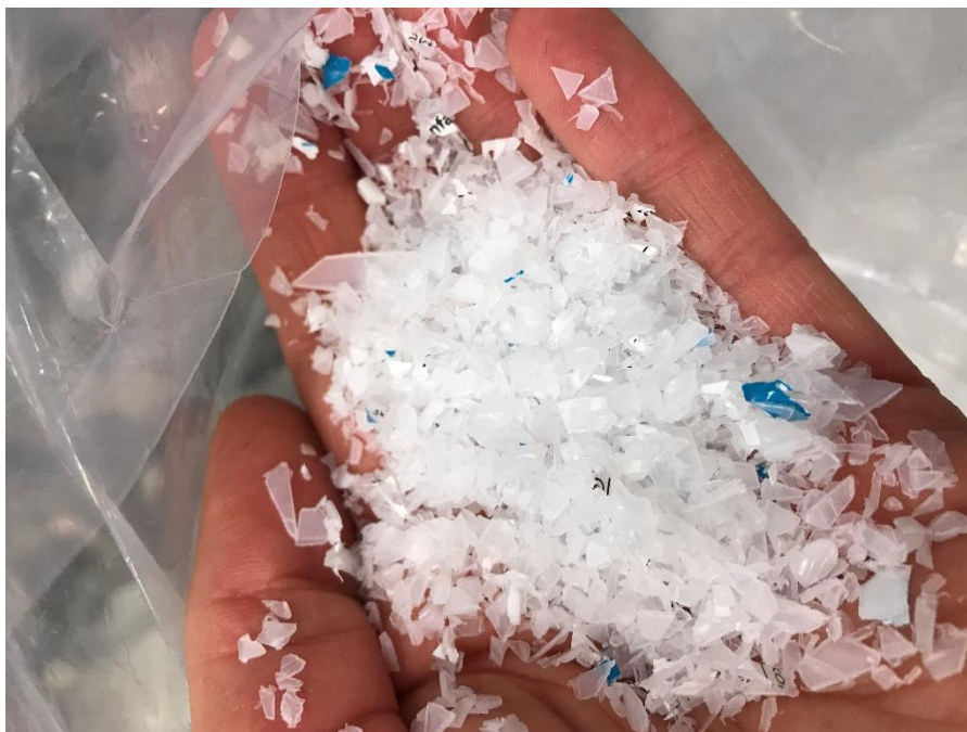
Figur 10: Mald HDPE flaska där de blåa bitarna kommer från etiketterna. Flingorna har en storlek på 1–2 mm.
