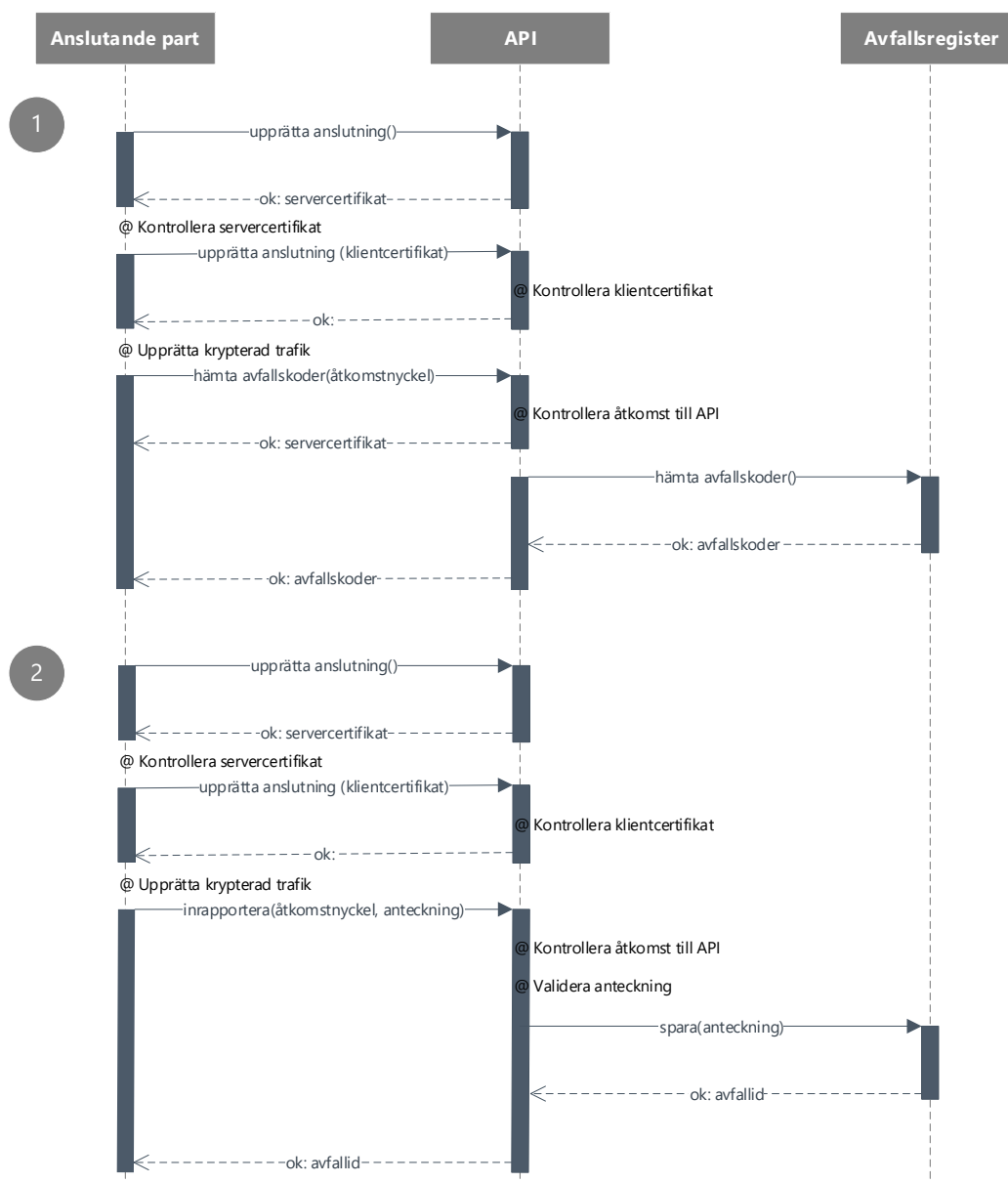
Figur 2: Exempel på två olika anrop, först en hämtning av en värdelista, sedan en inrapportering av en anteckning, som alltid svarar med ett avfalls-id. Varje anrop påbörjas med att en ömsesidigt säker kommunikation upprättas, och följs av själva anropet till API:et, som alltid kvalificeras med en API-nyckel (åtkomstnyckel, eng. access token).
