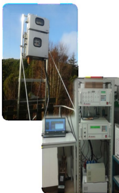
Figur 2. Placering av luftintaget för mätning av kvicksilverspecier i luft med automatisk metod. Här visas instrumentet Tekran 2537B, 1130/1135.
